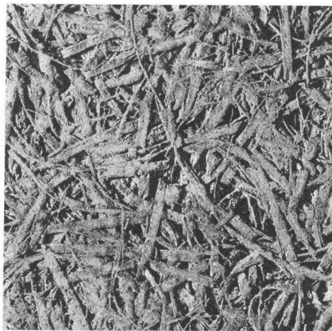
Struktur einer unbeschichteten Heraklith-Leichtbauplatte
