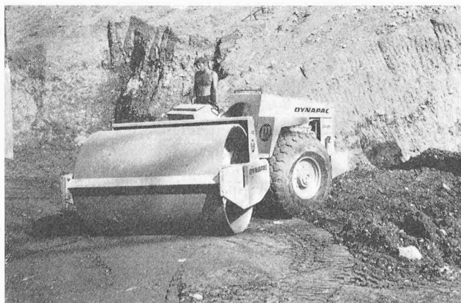
Bild 7. Selbstfahrende Vibrationsglattwalze Dynamopac CA 25 mit Knicklenkung, 9000 kg mit Dieselmotor Caterpillar von 125 PS
