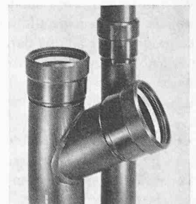
Bild 7. Formstücke aus Hartpolyäthylen (Akatherm) mit kraftschlüssiger Steckverbindung. Der Sperrring (weiss) verhindert ein Herausziehen des eingesteckten Rohres
