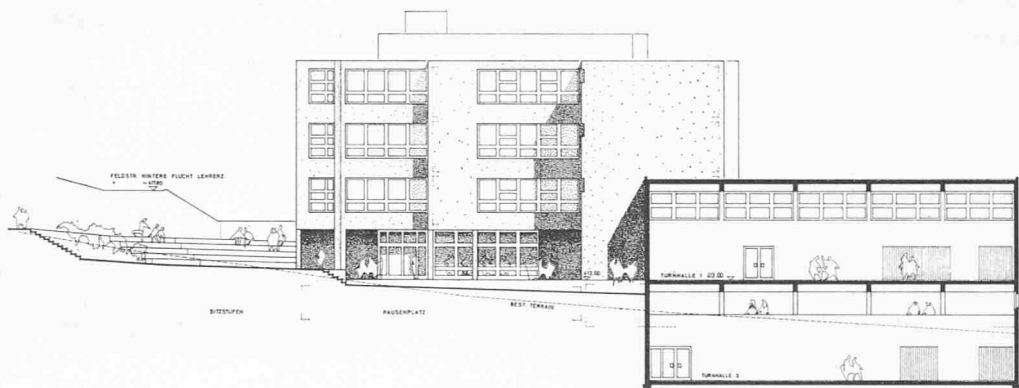
Südwest-Schnitt 1:500 durch Doppelturnhallengebäude mit Ansicht Klassentrakt 1
