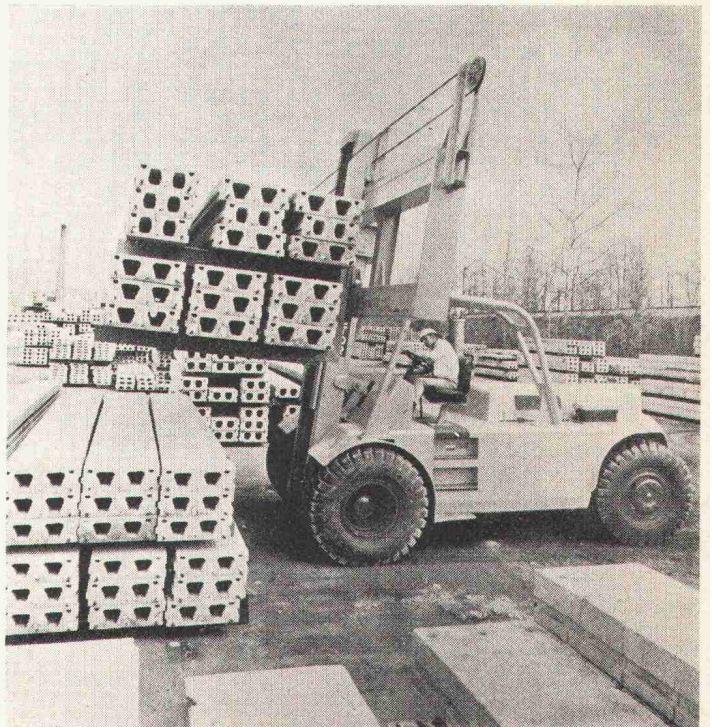
Bild 2. Caterpillar-Gabelstapler AH 60, Nutzlast 30 t
