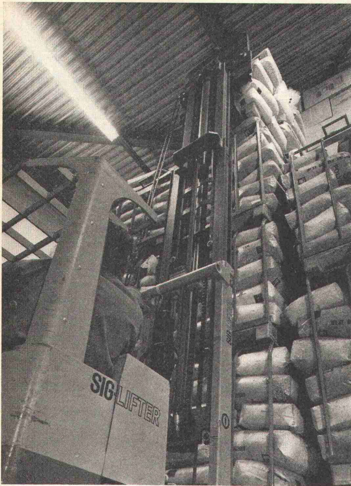
Elektro-Schubmaststapler «SIG-Lifter» mit Triplex-Hubmast für 6,2 m Hubhöhe
