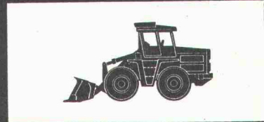
Radlader Europ L 1000 Motor: 120 SAE-PS Schaufeln: 1,1–1,8 m 3 Gewicht: 7800 kg
