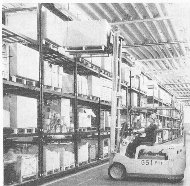
Bild 5. Der Stapler kann vier Felder des Palettenregales bedienen. Der 2,5-t-Stapler braucht allerdings trotz der um 180 Grad drehbaren Achse einen breiten Bedienungsgang (Bild SE-Fahrzeugwerke)
