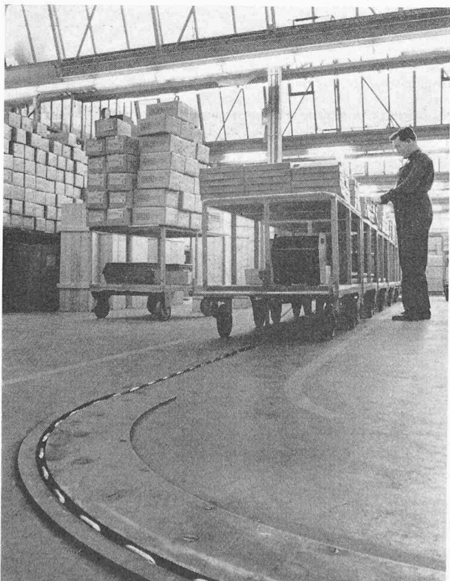
Bild 9. Mit einer bodenversenkten Förderkette werden die Sammelwagen des Lagers mit der Fertigung oder dem Versand verbunden. Mit Stift bekommen sie einen Zielsteuerungsbehehl, um an dem gewünschten Ort ausgeschleusst zu werden
