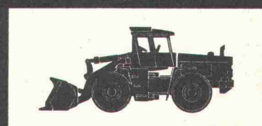
Radlader Europ KL 30 Motor: 240 SAE-PS Schaufeln: 2,5–4,8 m 3 Gewicht: 17200 kg
