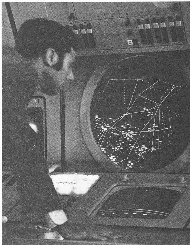
Ein wichtiges Instrument des Madap-Systems ist die Darstellung der Luftlage in synthetischer Form auf graphischen Bildschirmen. Das Bild zeigt ein solches «graphisches Lichtbild», mit dessen Hilfe die Flugbewegungen ständig verfolgt werden können
