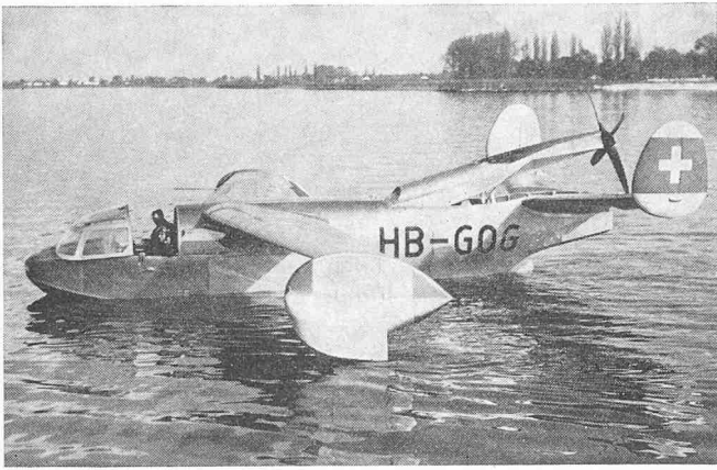
Das amphibische Flugzeug Dornier Do 212 mit schwenkbarer Luftschraube hinter dem Leitwerk. Leistung 450 PS, Gewicht 2,3 t (Entwicklung 1938 bis 1941) (Werkphoto FFA)
