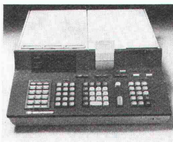
Tischrechner Modell 9810A mit 2036 Programmschritten, 111 Datenspeichern und exklusivem Textausdruck auf dem Streifen drucker.
