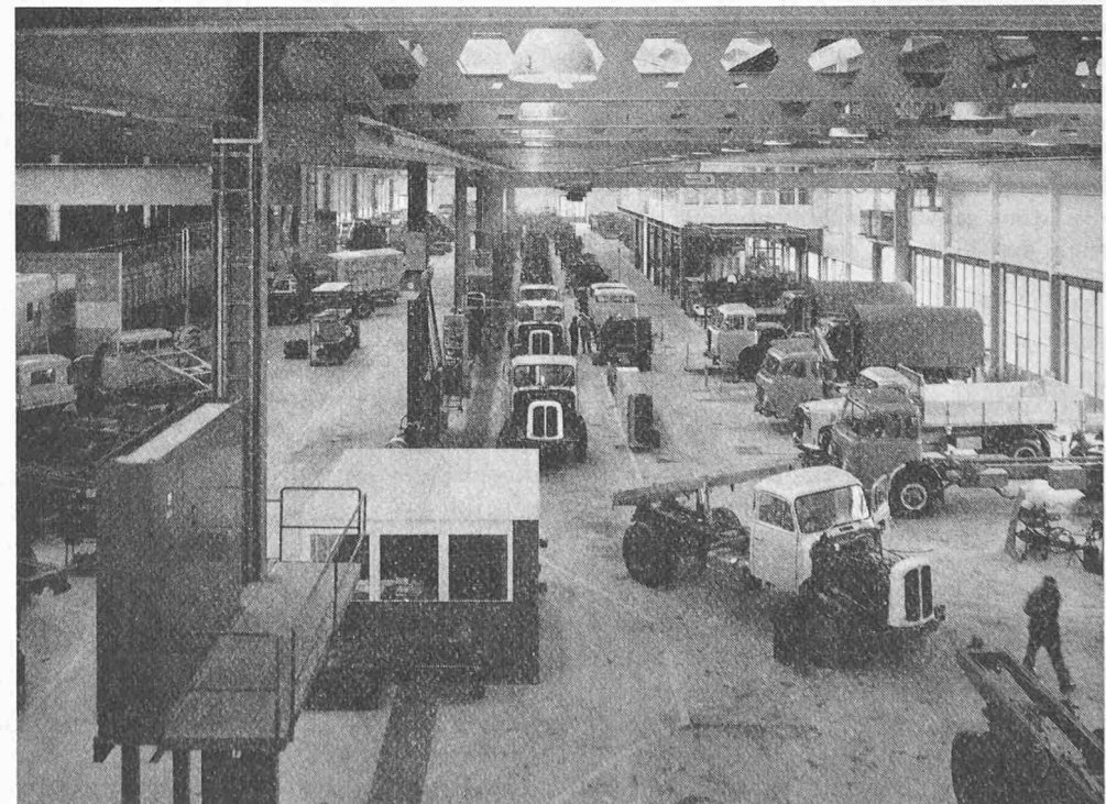
Bild 7. Blick in die neue Montagehalle, gesehen von Ost nach West. Links die Verlagsmontage, rechts die Chassismontage, im Vordergrund rechts die Nacharbeitsplätze, im Hintergrund das Montageband
