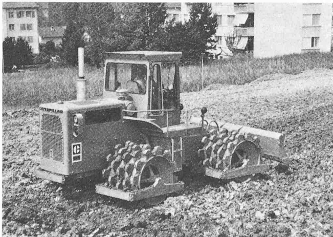
Bild 5. Selbstfahrender Caterpillar-Tamping-Verdichter 815. Einsatzgewicht 18,1 t
