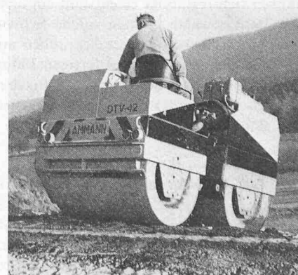
Bild 3. Doppel-Tandem Vibrationswalze DTV-42, Gewicht 4400 kg, Walzendurchmesser 920 mm, Walzenbreite 1230 mm, Mittelpunktklenkung-Doppelantrieb
