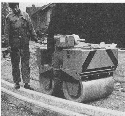
Bild 1. Doppel-Tandem Vibrationswalze DTV-12, Gewicht 850 kg, Walzendurchmesser 480 mm, Walzenbreite 700 mm, Mittelpunktklenkung-Doppelantrieb
