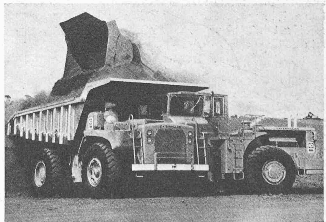
Bild 4. Eine 12-m 3 -Ladeschaufel belädt einen 50-t-Muldenkipper
