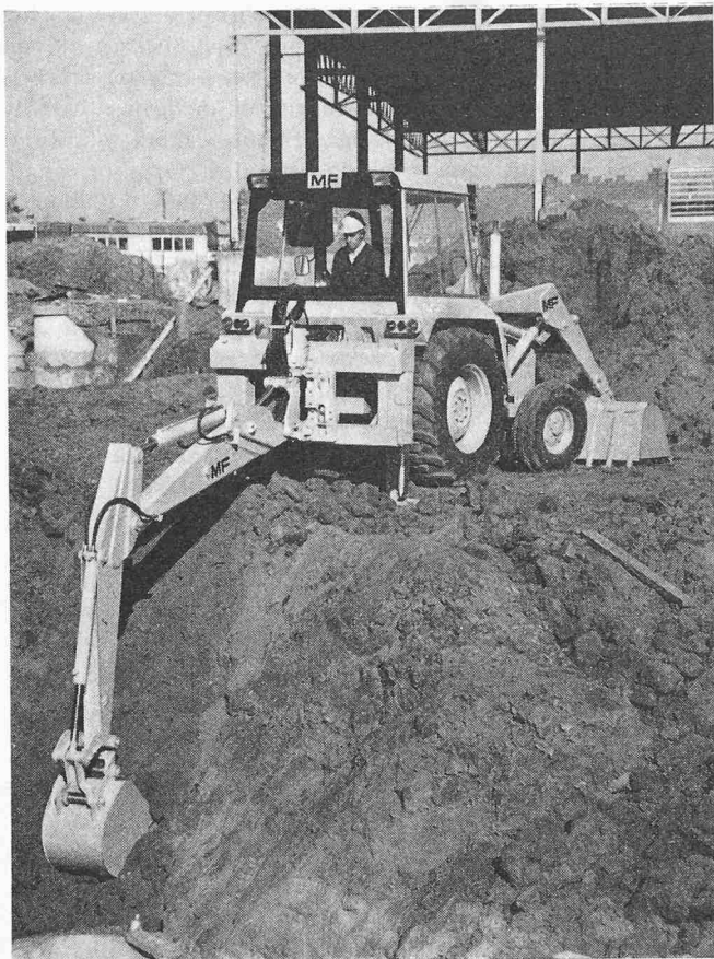
Tiefelöffelbagger Massey-Ferguson 50B. Leistung der hydraulischen Pumpe 62 PS. Grösste Aushubtiefe 4,8 m, Hubfähigkeit (bei vollausgefahretem Ausleger ohne Schaufel) 860 kg
