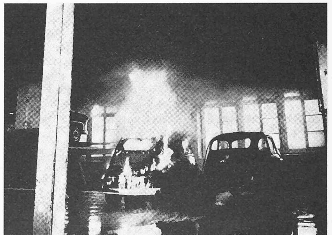
Bild 2. Vollbrand eines Personenwagens in einer Garage. Obwohl der Wagen ausbrennt, erleiden die Nachbarwagen nur geringfügige Schäden [4]
