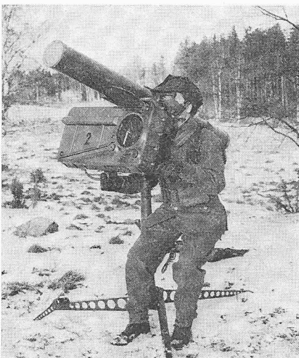
Bild 2. Links: Die Flab-Lenk Waffe RBS-70 mit Schütze in Feuerstellung
