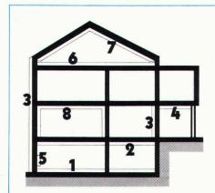
Styropor-Vollwärmeschutz beginnt im Keller und endet im Dach. Deshalb sind an folgenden Gebäudeteilen Styropor-Hartschaumplatten zu verlegen:
