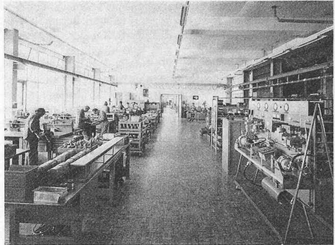
Luftapparate-Abteilung: Revisionen und Reparaturen von ausgebauten Aggregaten
