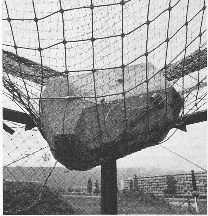
Bild 5. Block von einer Tonne Gewicht nach dem Aufprall. Zwar wurde das Netz örtlich gedehnt, doch der grösste Teil der Energie ist durch die Bremsung absorbiert worden
