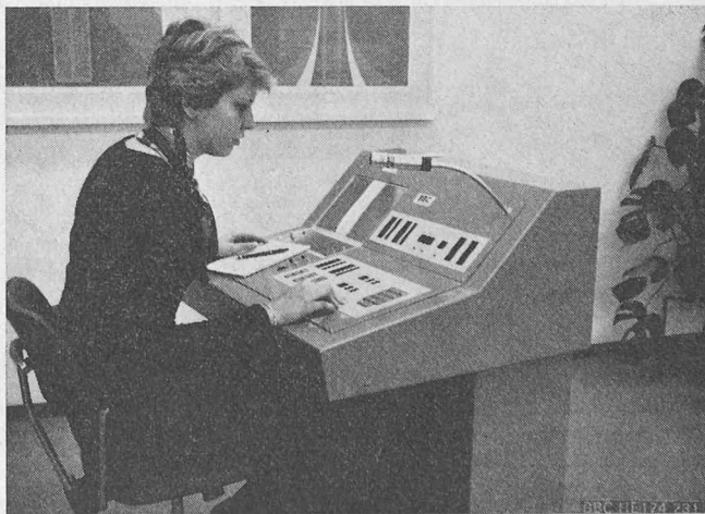
Mikroprozessorgesteuertes Einsatzleitsystem, Steuerpult
