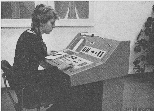
Mikroprozessorgesteuertes Einsatzleitsystem, Steuerpult
