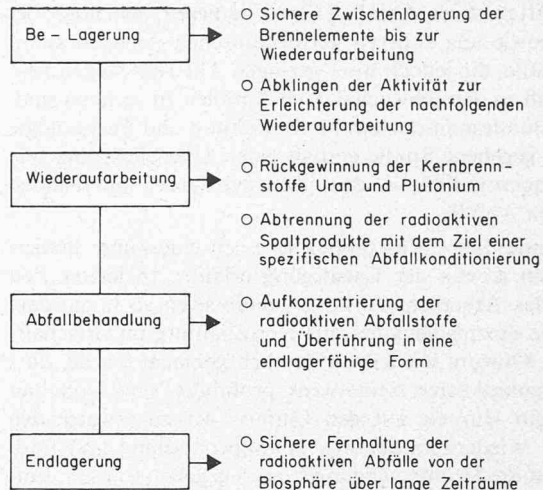
Bild 2. Ziele und Zwecke der einzelnen Teilschritte in der Entsorgung
