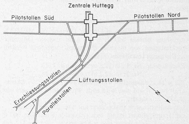
Bild 5. Pilotstollennetz des Baulos «Huttegg»
