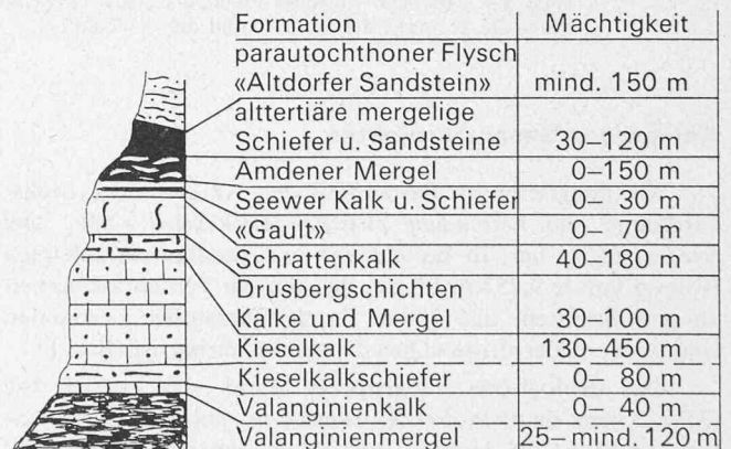
Bild 2. Geologisches Längsprofil durch die Tunnelachse mit Schichtprofil (R. T. Schneider, Urikon)
