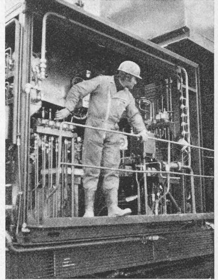
Bild 21 und 22. Gesamtansicht des «Mine-Cars». Es sind die zwei Boxen mit insgesamt vier Türen, die Antriebsgruppe und der Hydrokuli zu erkennen. Im Vordergrund sieht man die Schiebebühne, die es erlaubt, mit den Schienenmischern vom Hauptgeleise aufs Geleise der Betonanlage zu gelangen. Sie musste eingebaut werden, weil mit den schweren «Mine-Cars» keine Weichen befahren werden dürfen (links). Fahrerstand mit Power Unit des «Mine-Cars» (rechts)
