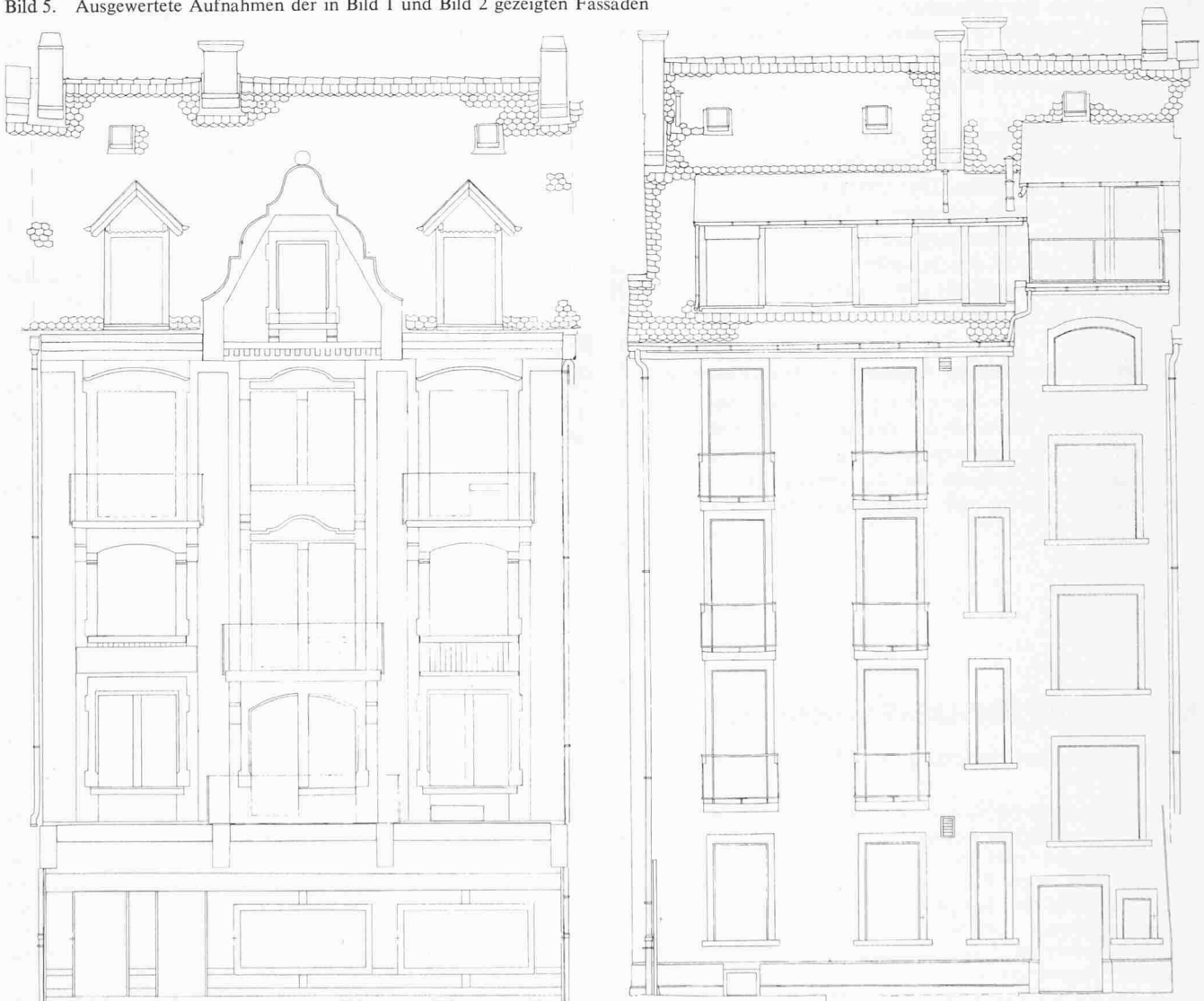
Bild 5. Ausgewertete Aufnahmen der in Bild 1 und Bild 2 gezeigten Fassaden
