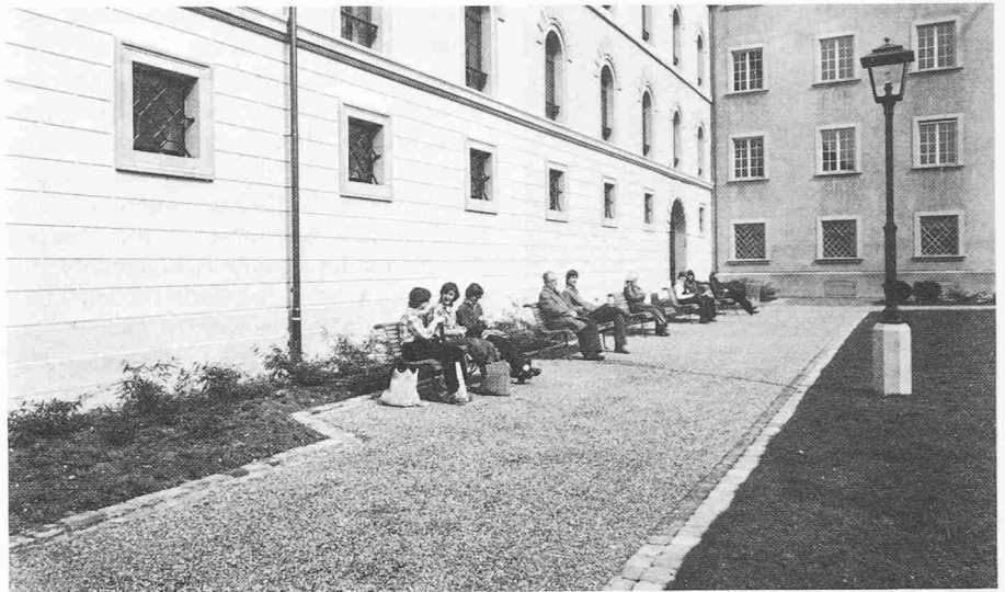
Der neugestaltete Klosterhof. Niedere Rabatten und Sitzbänke tragen zur Wohnlichkeit des Platzes bei, ohne dessen Grosszügigkeit und Herbeheit zu beeinträchtigen. Der bitumengebundene Kiesbelag entspricht in seinem Aussehen den kunsthistorischen Ansprüchen
