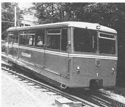
Bild 6. Elektrischer Zahnrad-Triebwagen der Dolderbahn in Zürich
