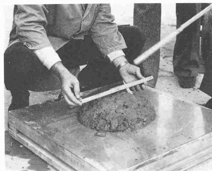
Bild 4. Messung des Ausbreitmasses am Ausgangsbeton (Ausbreitmass = 34 cm)
