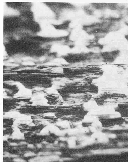
Bild 1. Oberflächliche Holzerosion durch Solarstrahlung, Bläuepilze und Regen
