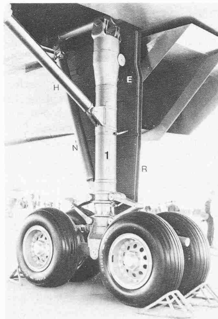
Bild 11. Linksseitiges Haupt-Fahrgestell des Überschallflugzeuges «Concorde». 1: Haupt-Zylinder des Fahrgestells mit eingebauter Stossdämpfung (siehe Bild 12); H: Hilfs-Zylinder für das Einziehen des Fahrgestells während des Fluges ins Innere des Flugzeugflügels; N: zweiter Hilfszylinder; E: grosses, zum Herunterlassen des Fahrgestells aufklappbares Segment der Flügel-Unterseite. Man beachte die an der mit «R» bezeichneten Stelle besonders gut sichtbare, durch Fräsen hergestellte, profilartige starke Verrippung der dem Flügelinnern zugekehrten Innenseite des Beplankungssegments. (Photo: Pneumatiques Kleber-Colombes S.A. Paris. Hersteller des Fahrgestells sind die zur SNECMA-Gruppe gehörenden Hispano-Suiza-Werke)
