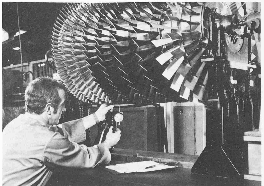
Bild 25. Beschauelung des Kompressors des zum Antrieb des Düsenjägers «Mirage» von der «SNECMA» entwickelten Triebwerkes ATAR (Bei der im Bild gezeigten Ausführung handelt es sich um eine in Europa ausserhalb der Schweiz gebaute Variante)[15]
