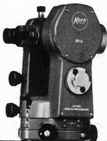
Kern K 1-S. Ingenieurtheodolit mit Skalenablesung
