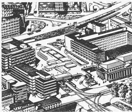
Überdeckung einer innenstädtischen Verkehrsfläche durch einen Platz für Fussgänger mit Läden, Wasserspielen usw. Kl. Schlossplatz, Stuttgart, 1968
