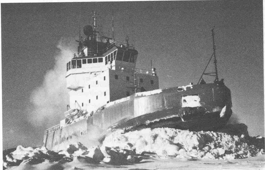
Arktis-Versuchseisbrecher «Kigoriak», angetrieben von zwei Sulzer-Motoren Typ 12ZV40/48
