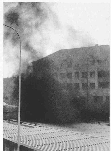
Bild 6. Aubruggtunnel Zürich, Brandversuche: Austritt des Rauchs aus dem mit Gittern überdeckten Tunnelende
