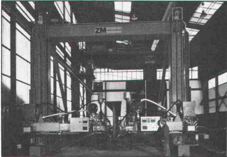
Produktionseinrichtungen bei Zwahlen & Mayr SA: automatisches Schweissanlage
