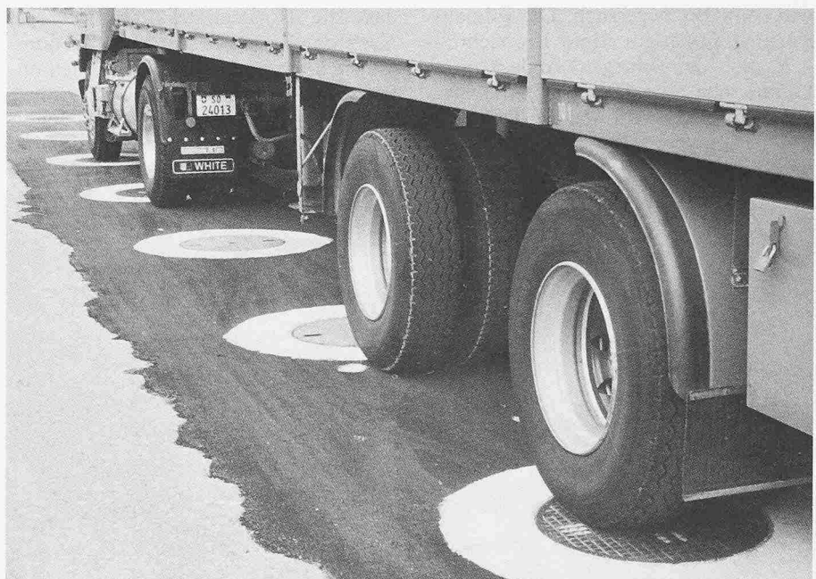
Bild 3. Anordnung der Belastungsversuche mit einem Sattelschlepper
