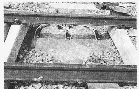
Bild 2. Druckdosen unter dem Schotterbett
