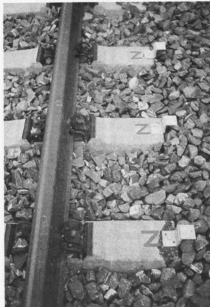
Bild 4. Messpunkte für Einsenkungsmessung
