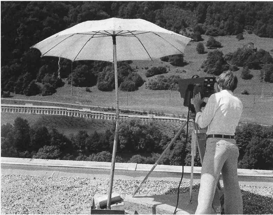
Bild 6. Bewegungsmessungen mit Präzisionsentfernungsmessgerät an Wand und Hang beim Nordportal
