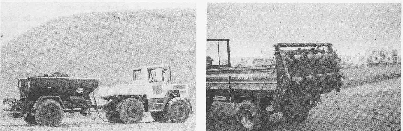
Bild 8. Streuversuche mit zwei verschiedenen Mistzettern
