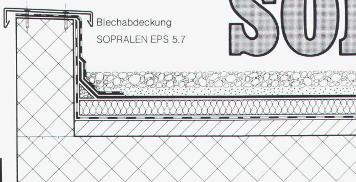
Schutzschicht SOPRALEN EJ 3.5 + EV 3.2 Wärmedämmschicht Dampfsperre
