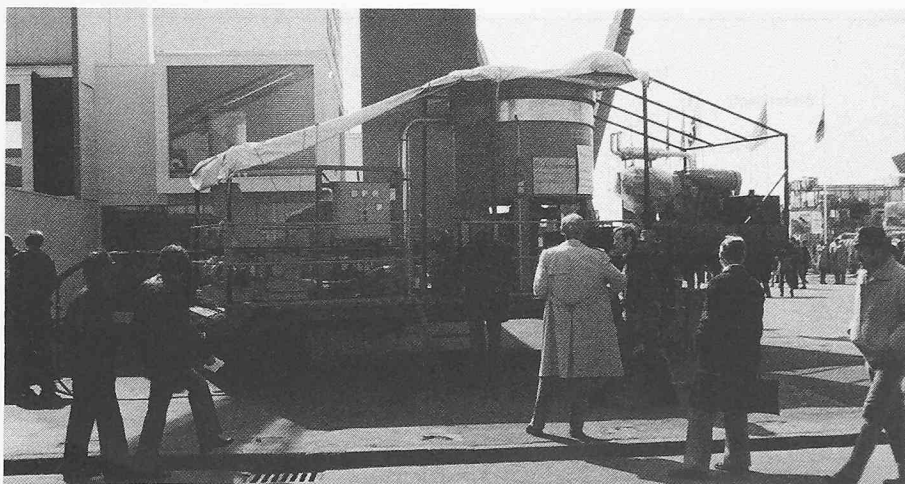
Brikettierungsanlage für Stroh. Links: Ausstoss der Pellets, Mitte: Einfülltrichter für Rohmaterial und Kolbenpresse
