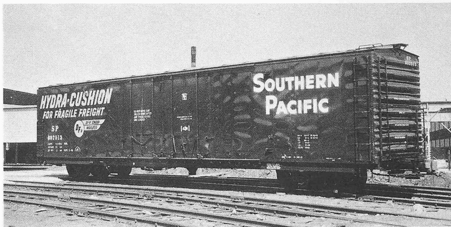
Bild 2. Geschlossener vierachsiger Güterwagen amerikanischer Bauart beim Verlassen des Herstellerwerkes in fabrikationsneuem Zustand.
