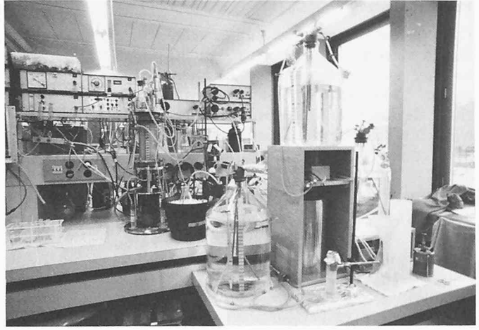
Labor-Kleinreaktor 2 Liter. Kleinanlagen werden hauptsächlich zu folgenden Aufgaben beigezogen: Biochemische Fragestellungen, Erarbeitung von Prozessgrundlagen, Ausbildung. Im Zentrum des Bildes der Bioreaktor, dahinter die zugehörige Mess- und Regeltechnik, im Vordergrund die Vorratsgefässe für Nährmedien
