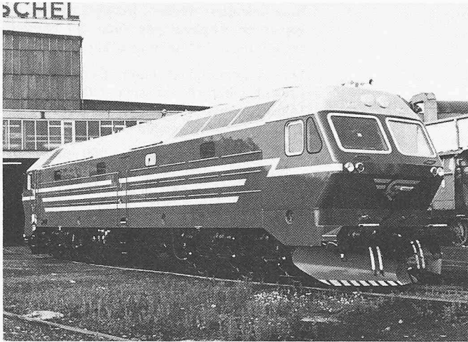
Bild 11. Diesellokomotive Di 4 der Norwegischen Staatsbahn; 3800 PS (2795 kW)
