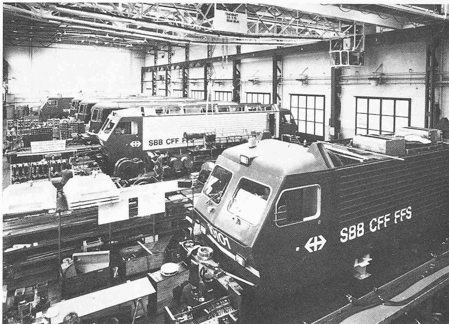
Bild 4. Lokomotive Serie Re 4/4 IV der Schweizerischen Bundesbahnen. Prototypen
