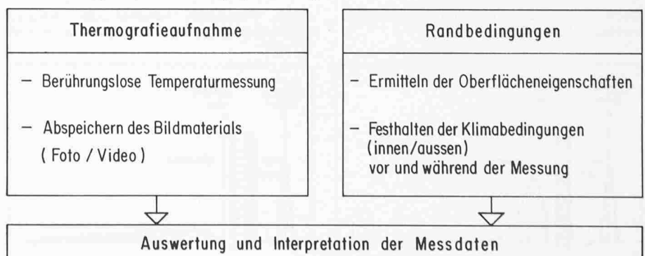
Bild 1. Ablaufprinzip einer Thermographiemessung
