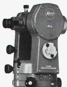
Kern K 1-S. Ingenieurtheodolit mit Skalenablesung
