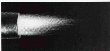
Flammenbild eines Oertli Ceramic-Brenners mit 1,0 kg/h Ölleistung.
