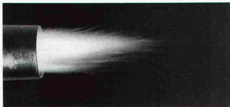
Flammenbild eines Oertli Ceramic-Brenners mit 1,0 kg/h Ölleistung.
