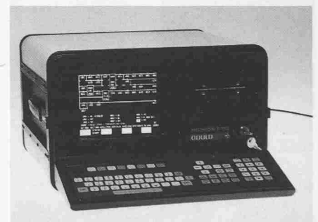
Bild 4. Programmier- und Steuergerät (Modicon). Power-flow als Servicehilfe
